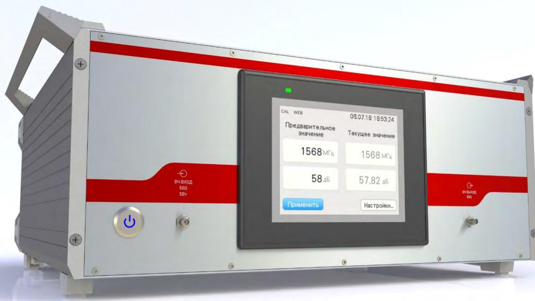
АТ-8 - позволяет изменять ослабление тракта в диапазоне частот от 0 до 8.5 ГГц. В отличие от аналогов рассчитан на большую входную мощность 25 Вт.
