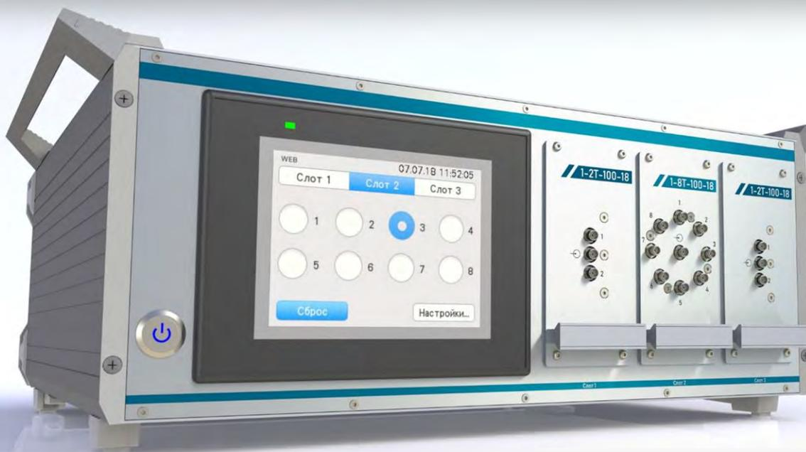
К-18 - это модульная коммутационная платформа, которая позволяет легко выполнять функции РЧ-переключателя и управления. Коммутационную платформу можно использовать в широком спектре приложений, начиная с простых функций СВЧ коммутатора до участия в построении систем измерений ЭМС.
